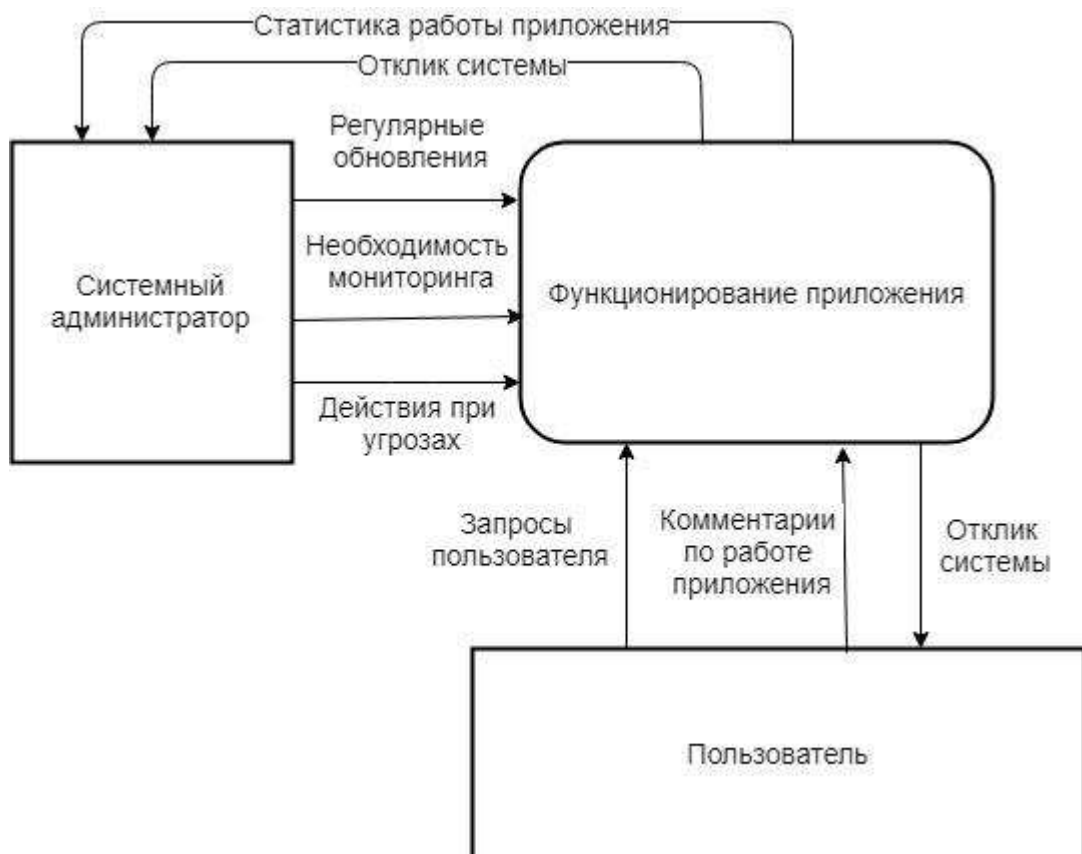
Рисунок – 10 Контекстная диаграмма «Функционирование приложения «Дорохово–online» с точки зрения взаимодействия с оператором»
