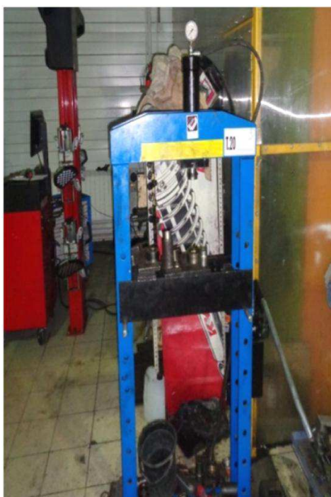
Рисунок 1.5 – пресс для выпрессовки запрессованных деталей.
