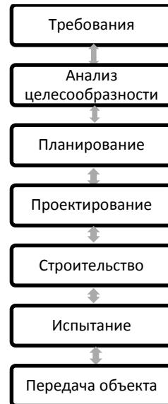
Рисунок 3 – Предиктивная модель жизненного цикла проекта
