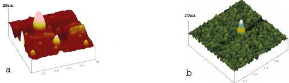
Рис. 2. Изображение пленки Ni толщиной 17,5 нм при наблюдении под углом 45^\circ : а — до отжига; б — после отжига
