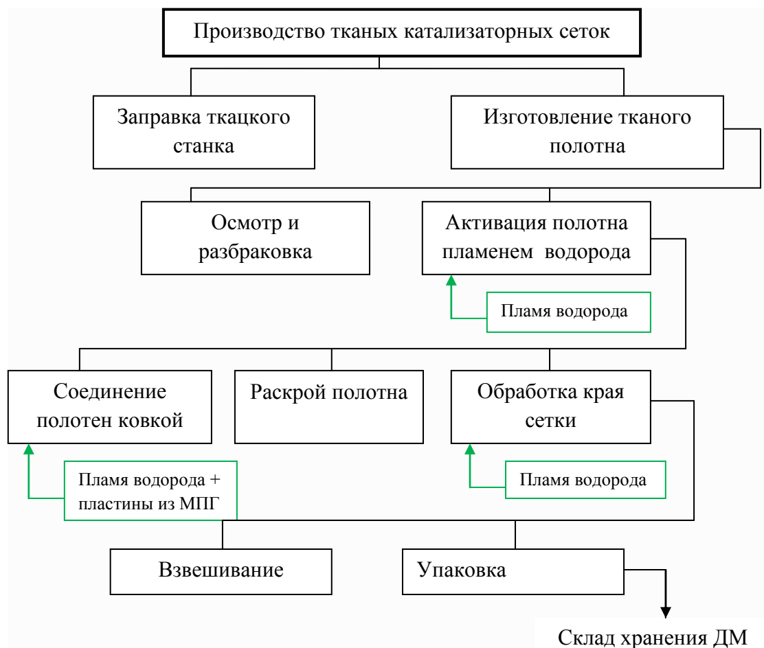
Рисунок 2 – Процесс производства тканых катализаторных и уловительных сеток
