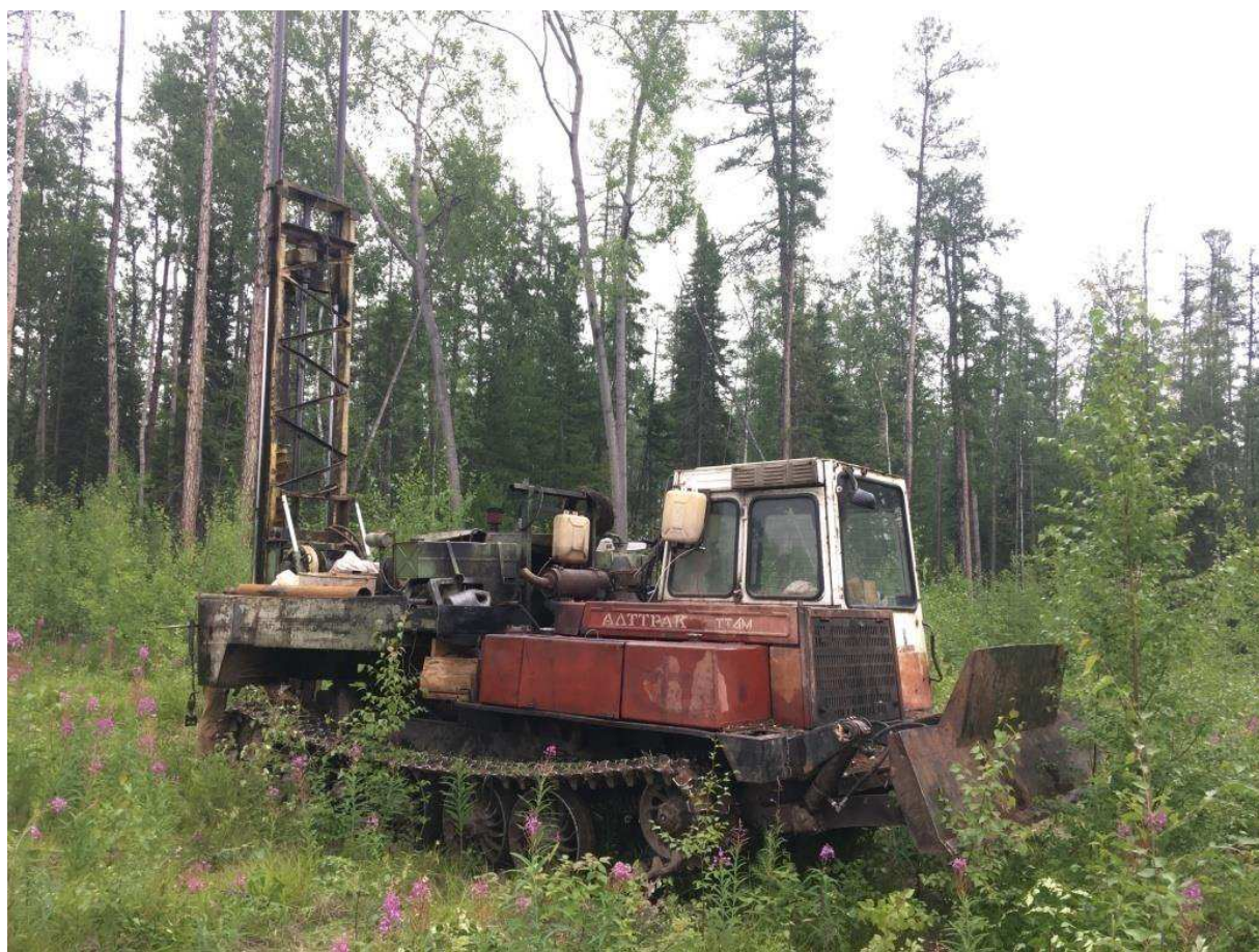
Рисунок 3.1 – Буровая установка ПБУ-2 на базе ТТ-4М
