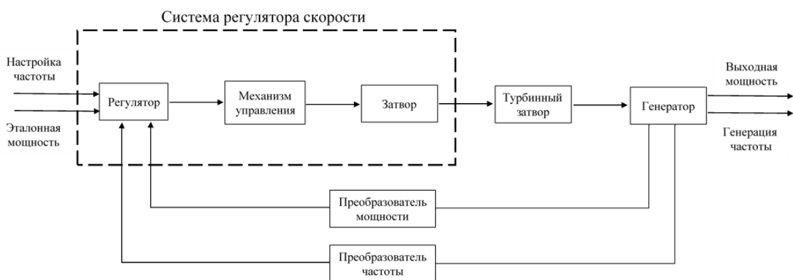
Рисунок 2.1 – Функциональная блок-схема гидроэлектростанции
