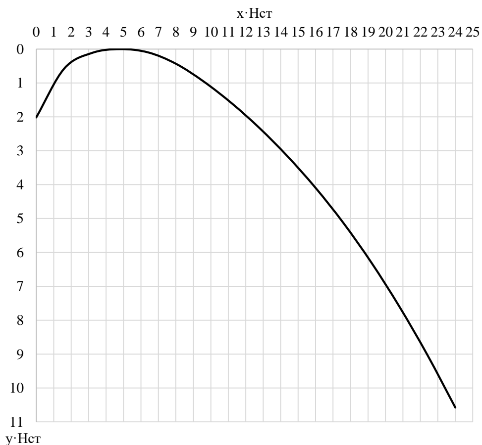
Рисунок 6.2 – Оголовок водосливной плотины
