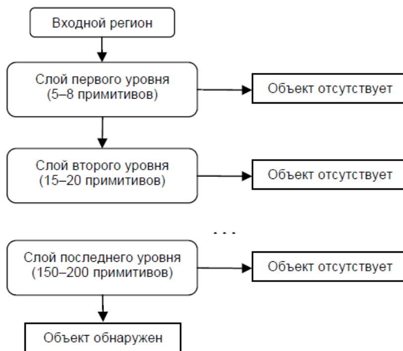
Рисунок 8 – Каскадная классификация в методе Виолы-Джонса.
