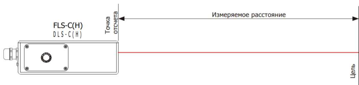
Рисунок 9.2 – Принцип работы дальномера
