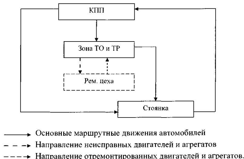
Рисунок 1.3 – Схема технологии ТО и ТР
