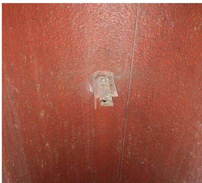
Рисунок 3 – Струна прямого отвеса
