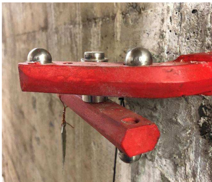
Рисунок 4 – Универсальный настенный трёхосный щелемер
