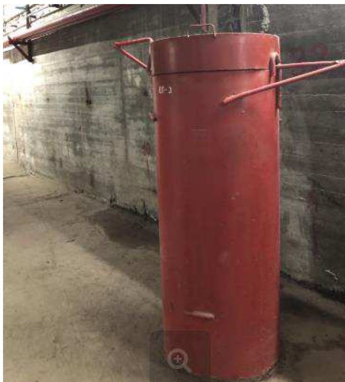
Рисунок 2 – Закрепленный якорь прямого отвеса
