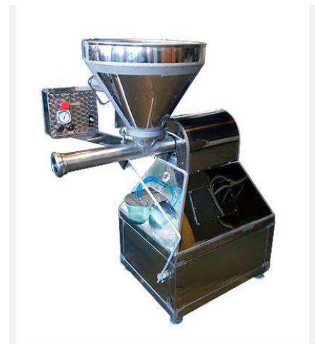
Рисунок 3. 3 – Вакуумный шприц модель CX-1149 «Идир»
