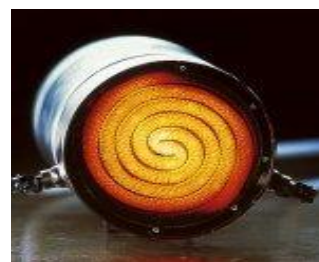
Рисунок 1 - Раскаленный катализатор в процессе работ
