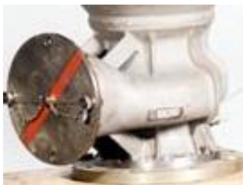
Рис. 1. Корпусная деталь ТНА [ http://www.yuzhmash.com/ru/product.php?page=uzliavto ]
