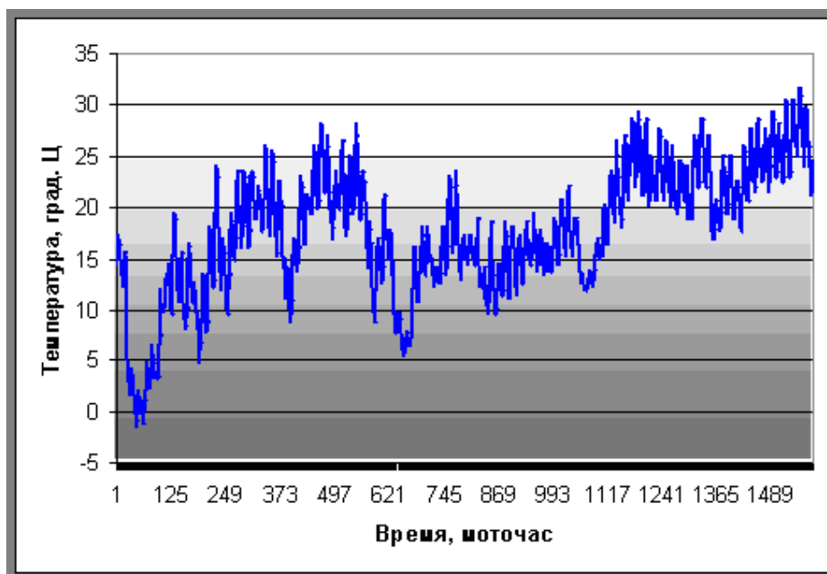
Рисунок 3.3 - Графическая интерпретация результатов работы АФП-гамма в режиме "Электронный самописец". На примере измерения температур (первичный датчик - термистор Omega 44030)
