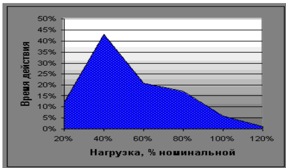
Рисунок 3.4 - Графическая интерпретация результатов работы АФП-гамма в режиме «Накопитель»
