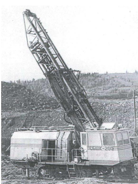
Рисунок 1.6 – Комбинированный буровой станок СБШК-200
