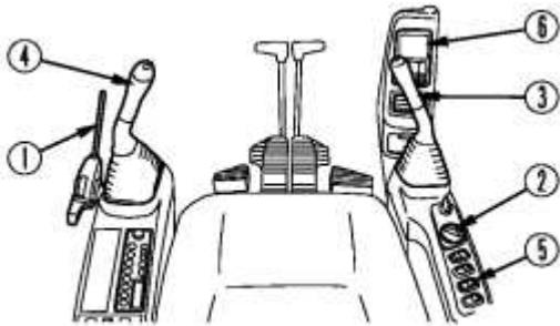
Рисунок 2.6.1 – Органы управления экскаватором
