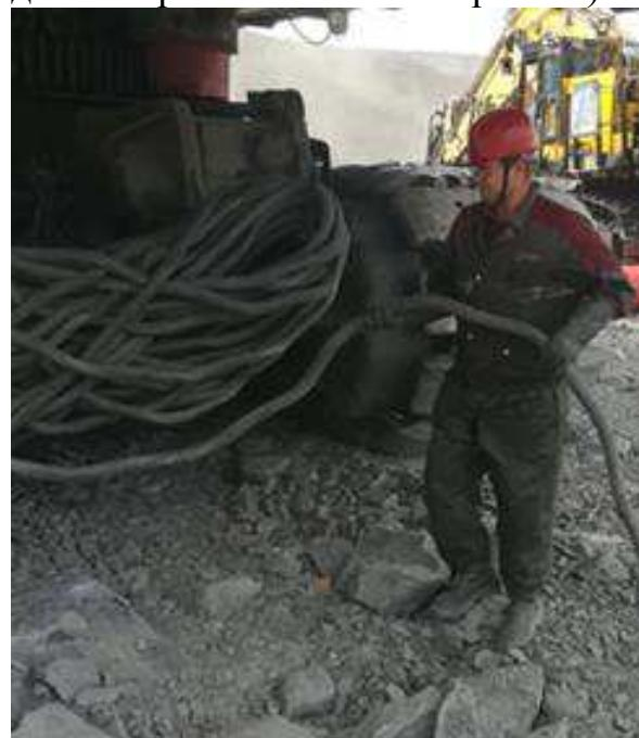
Рисунок 2.10.2.4 – Укладка кабеля во врем движении ЭКГ-10
