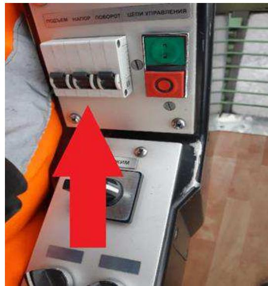
Рисунок 2.11.10 - Включение автоматов Подъем, Напор, Поворот
