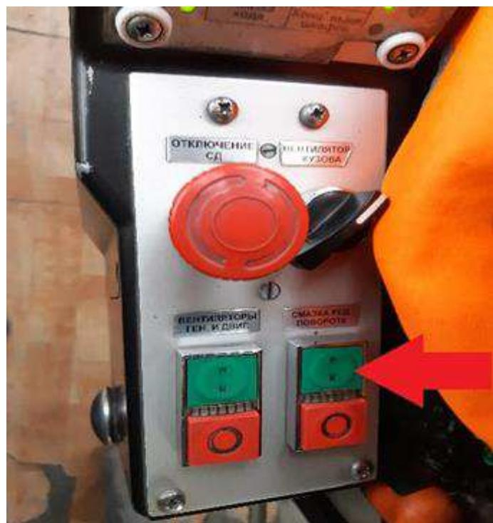
Рисунок 2.11.9 - Включение смазки редуктора поворота
