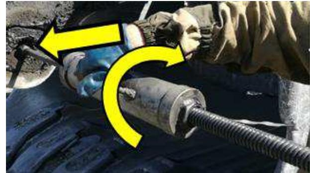
Рисунок 3.4.2 – Смазка узла
