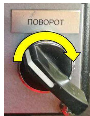
Рисунок 2.11.16 - включение поворота ключом
