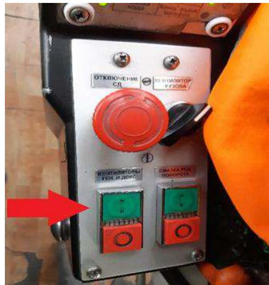
Рисунок 2.11.8 - Включение вентиляторов генераторов и двигателей
