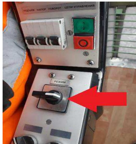
Рисунок 2.11.12 - Включение тумблера «Режим экскавации»
