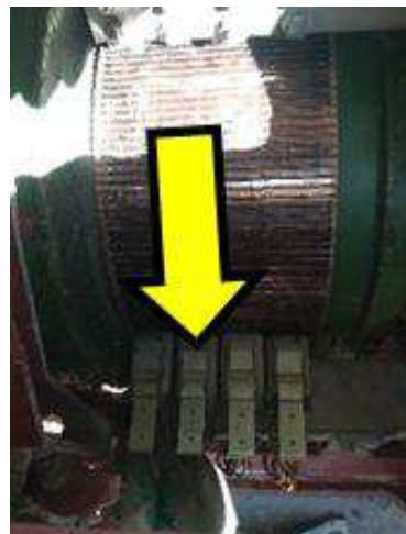
Рисунок 3.4.11 – Проверка щеток напорного электродвигателя
