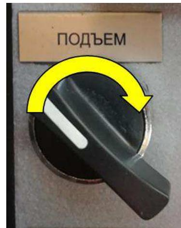
Рисунок 2.11.17 - включение подъема ключом
