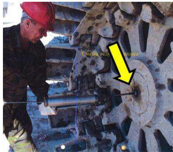
Рисунок 3.4.3 – Смазка ведущего колеса
