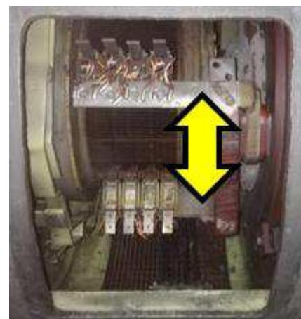
Рисунок 3.4.10 – Проверка щеток электродвигателей основных
