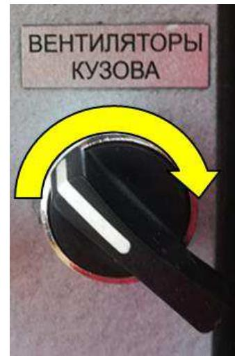
Рисунок 2.11.14 - включение кузовных вентиляторов ключом
