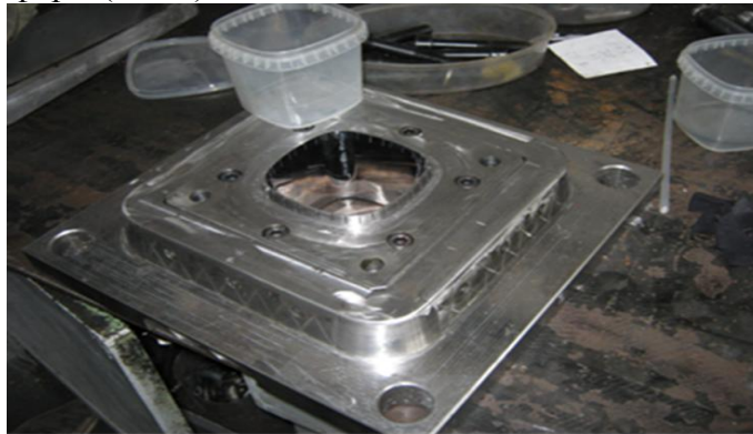
Рис.2. ООО «Абакан-Пласт», часть пресс-формы и банка.
