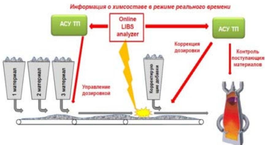
Рис. 4. Принципиальная схема автоматического дозирования компонентов сырьевой смеси на основании информации о ее химическом составе, поступающей в режиме реального времени
