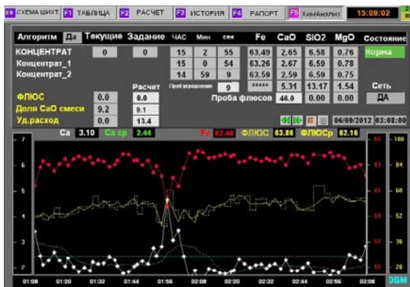
Рис. 7. Интерфейс системы автоматического дозирования флюсов в агломерационную шихту
