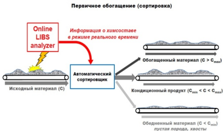
Рис. 3. Принципиальная схема автоматической сортировки дробленой руды на основании данных о ее химическом составе, поступающих в режиме реального времени
