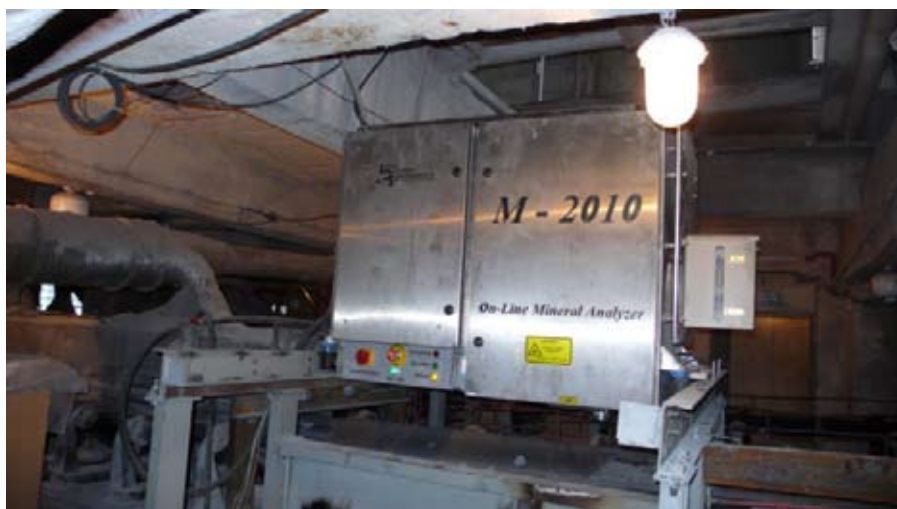
Рис. 5. Анализатор МАУА на дробильно-обогатительной фабрике комбината «Магнезит»
