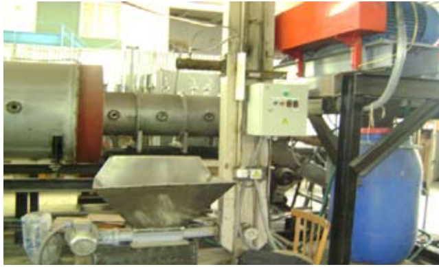
Рис. 1. Огневой стенд ИТ СО РАН тепловой мощностью 5 МВт
