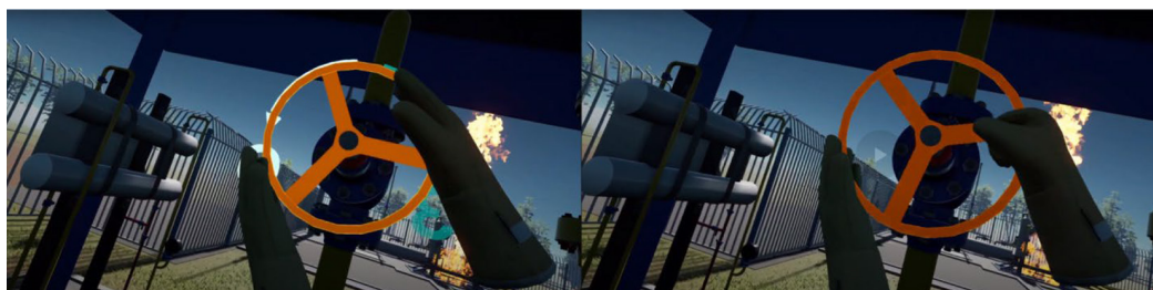
Рис. 1. Автоматический поворот вентилей в тренажере от District Zero (District Zero Keisy, 2024) Fig. 1. Automatic valve rotation in the simulator from District Zero (District Zero Keisy, 2024)
