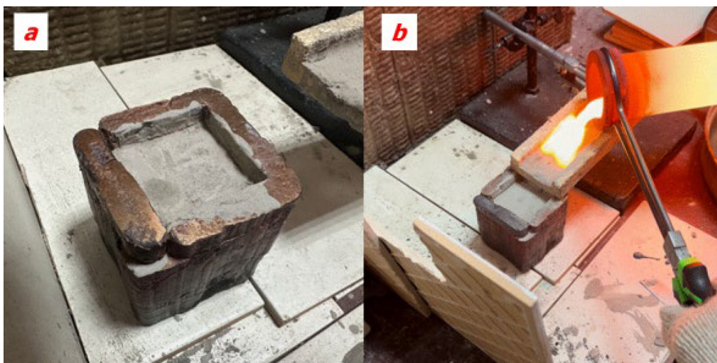
Рис. 1. Лабораторная изложница ( a – обработанная пульпой шамотного мертеля с помощью кисти и высушенная пламенем горелки, b – во время разливки меди)
