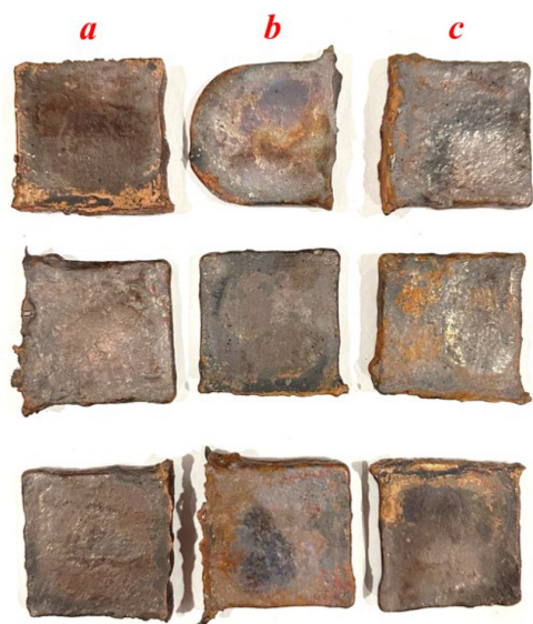
Рис. 3. Внешний вид медных пластин (Вариант 1) ( a – 1,0 мм; b – 0,5 мм; c – 0,1 мм)
