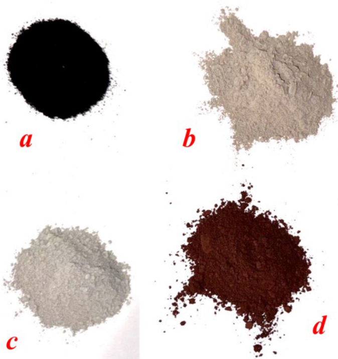
Рис. 2. Порошкообразные композиции – исходные компоненты противопопригарных покрытий ( a – сухой углеродистый остаток; b – шамотный мертель; c – синтетический ангидрит; d – «Литоформ»)
