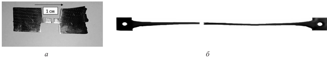
Рис. 1. Образец сплава 47XNM толщиной 0,5 мм: а – после отжига и растяжения при комнатной температуре; б – после сверхпластической деформации при 950 °С
