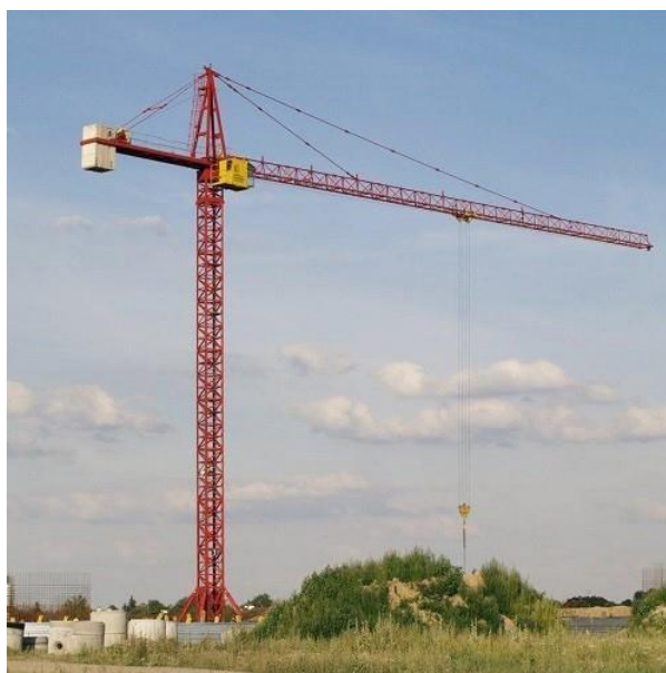
Рисунок 4.1 – Башенный кран KROLL K-160
