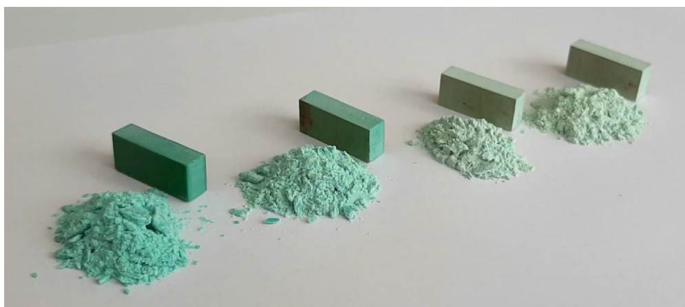
Рис. 1. Композиционный диэлектрический материал и образцы для определения диэлектрической проницаемости
