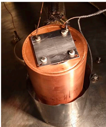
Рис. 4. Измерительная решётка на цилиндре Фарадея
