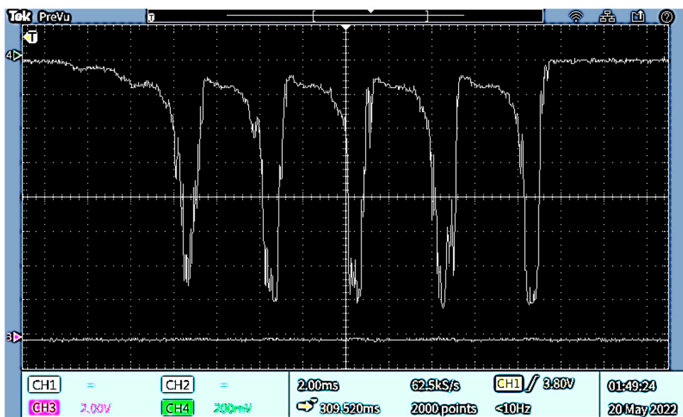
Рис. 5. Осциллограмма измерения профиля электронного пучка
