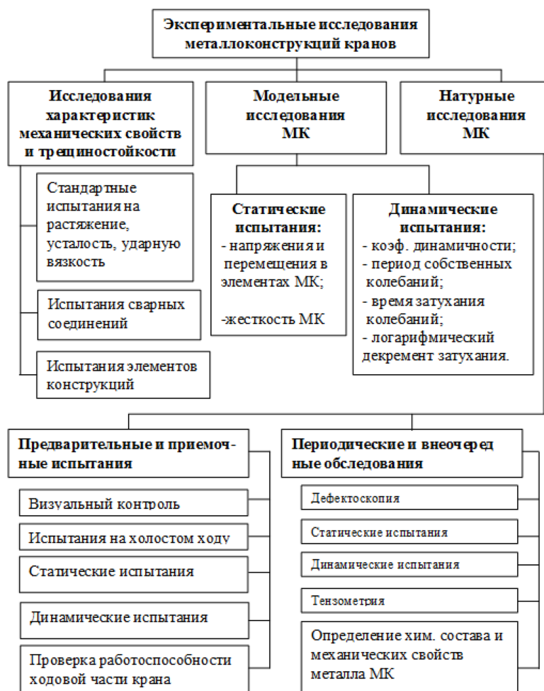
Рис. 2. Основные направления экспериментальных исследований металлоконструкций кранов
