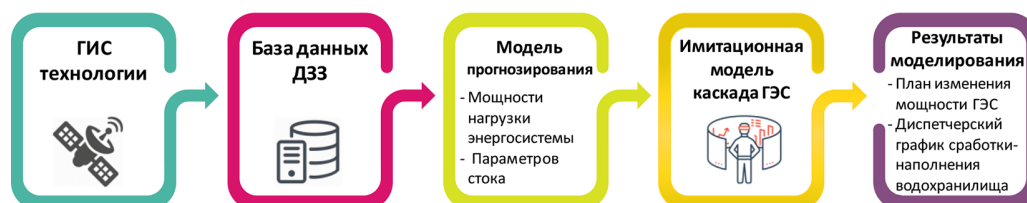
Рис. 1. Интеграция ГИС-технологий в имитационную модель каскада ГЭС
