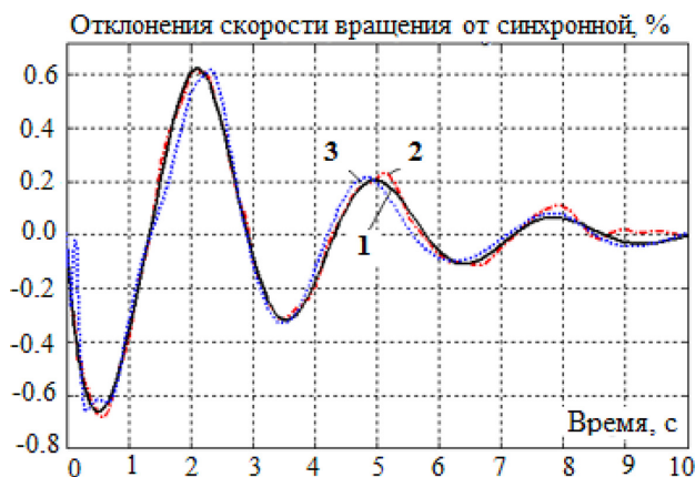
Рис. 5. Характеристика скорости вращения ротора генератора при подключении дополнительной нагрузки: 1 – экспериментальные данные; 2 – нечеткая оптимизированная модель без использования метода субтрактивной кластеризации (91 правило); 3 – нечеткая оптимизированная модель с использованием метода субтрактивной кластеризации (8 правил)
