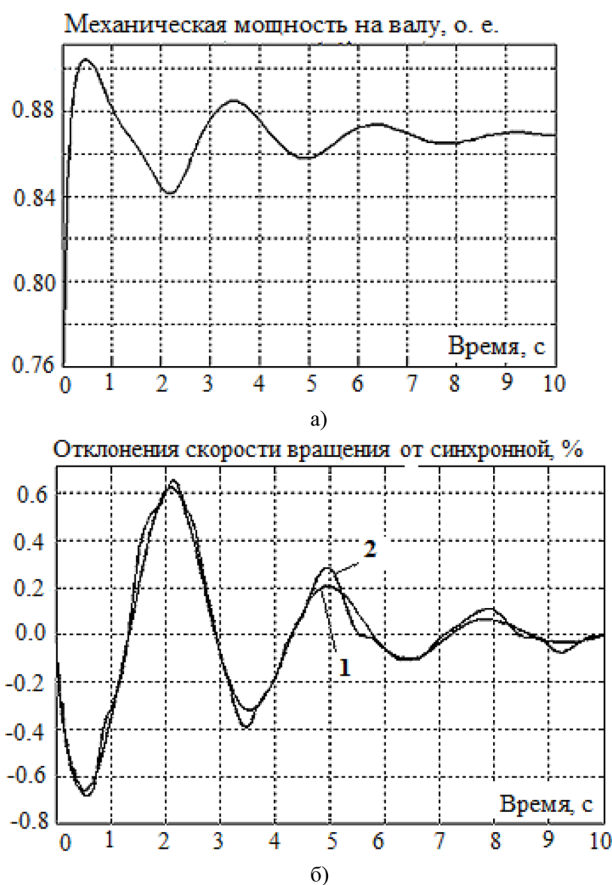
Рис. 4. Характеристики входного (а) и выходного сигналов (б): 1 – экспериментально полученная (эталонная) характеристика скорости вращения ротора генератора; 2 – характеристика скорости, сформированная с помощью системы нечеткого логического вывода
