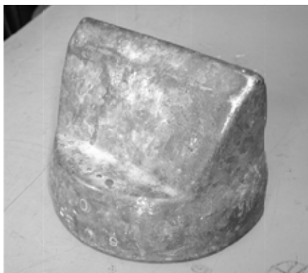
Рис. 2. Отливка рассекателя из стали 4Х5В2ФС, полученная методом ЭКЛ, \times 0,25
