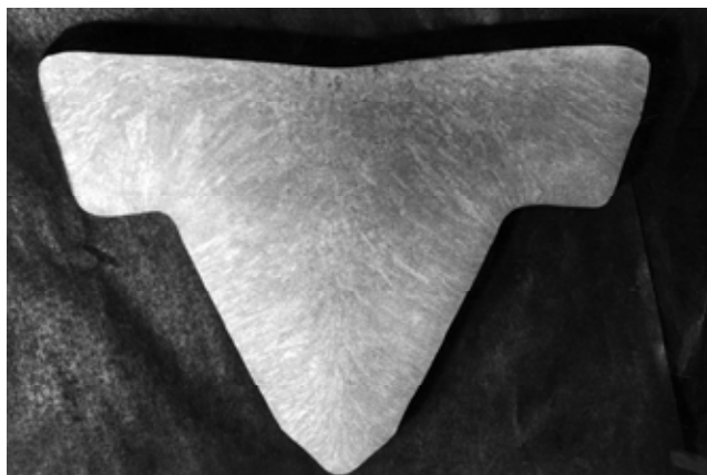
Рис. 4. Макроструктура рассекателя, имеющая транскристаллитное строение, \times 0,5
