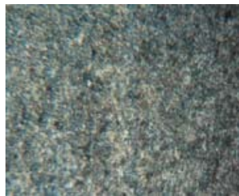
Рис. 2. Микроструктура образцов из стали 75ХМФ после отжига (x500)
