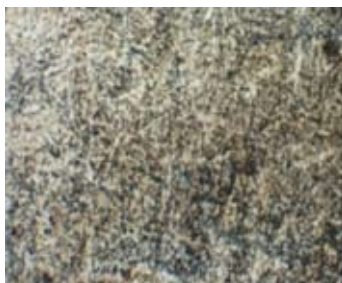
Рис. 19. Микроструктура образцов из стали 75ХМФ после термической обработки (x500)
