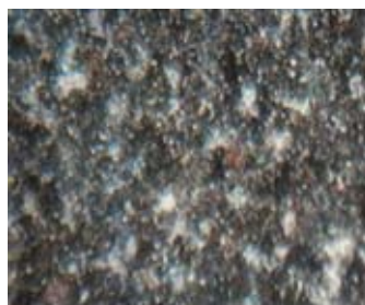
Рис. 16. Микроструктура образцов из стали 75ХМФ после термической обработки (x500)
