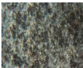
Рис. 11. Микроструктура образцов из стали 75ХМФ после термической обработки (x500)
