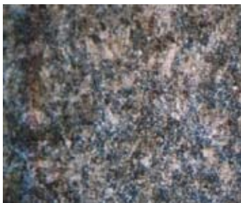
Рис. 8. Микроструктура образцов из стали 75ХМФ после термической обработки (x500)
