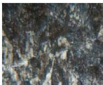
Рис. 6. Микроструктура образцов из стали 75ХМФ после термической обработки (x500)
