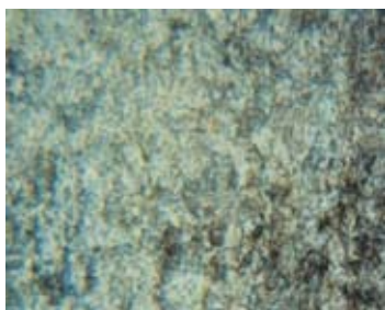
Рис. 18. Микроструктура образцов из стали 75ХМФ после термической обработки (x500)
