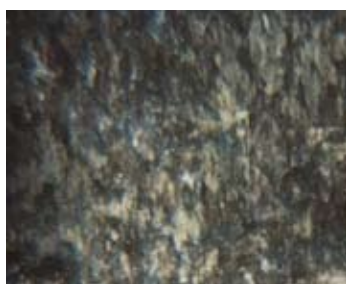
Рис. 5. Микроструктура образцов из стали 75ХМФ после термической обработки (x500)
