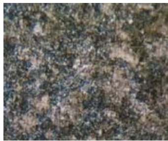
Рис. 9. Микроструктура образцов из стали 75ХМФ после термической обработки (x500)
