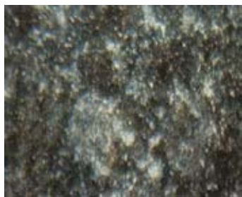
Рис. 15. Микроструктура образцов из стали 75ХМФ после термической обработки (x500)
