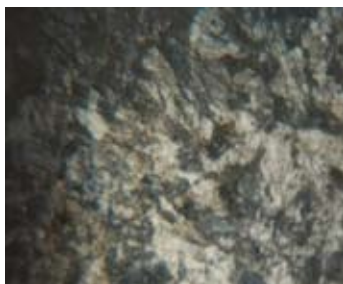
Рис. 7. Микроструктура образцов из стали 75ХМФ после термической обработки (x500)
