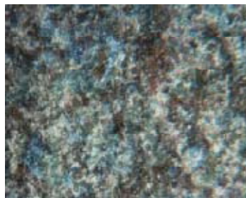
Рис. 4. Микроструктура образцов из стали 75ХМФ после термической обработки (x500)
