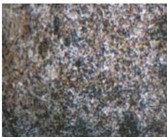
Рис. 22. Микроструктура образцов из стали 75ХМФ после термической обработки (x500)
