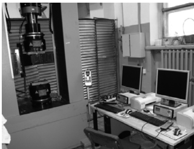
Рис. 3. Общий вид и пульт управления универсальной испытательной машины LFM усилием 400 кН
