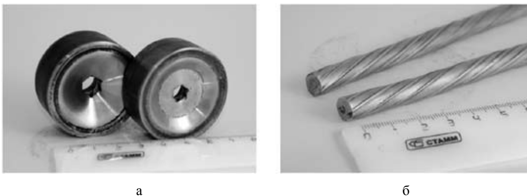
Рис. 4. Внешний вид матриц (а) с выполненными на калибрующем участке винтовыми проточками и образцы прутков (б), полученных с их применением
