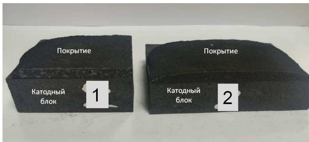
Рисунок 4.1 – Фотографии образцов покрытий, нанесенных на образцы подовых блоков
