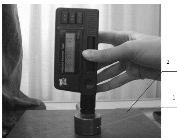
Рисунок 3.2 – Динамический твердомер ТН-130 (TIMEGroupInc): 1- образец; 2 - подставка
