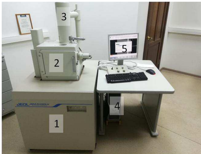
Рисунок 2.1 - Микроскоп JEOLJSM 6490LV: 1- стенд прибора с автоматической высоко/ низковакуумной системой и электронными системами управления; 2-камера для образцов; 3-электронно-оптическая система (колонна); 4- управляющий компьютер; 5- монитор
