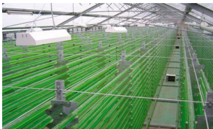
Рисунок 3.5 - Реактор закрытого типа
