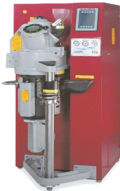
Исследования проведены на индукционной литейной установке Neutec 515 (США) с уникальной технологией пульсирующего силового перемешивания для повышения гомогенности расплава (рис. 1). В камеру печи подается инертный газ, создающий некоторое избыточное давление над зеркалом расплава. Слив осуществляется через отверстие в донной части тигля, которая закрывается графитовым штоком. Контроль температуры в центре расплава осуществлялся термопарой, вмонтированной в запорный шток тигля.
