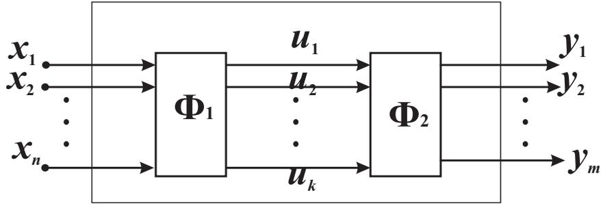
Рис. 1. Последовательная композиция двух комбинационных схем
