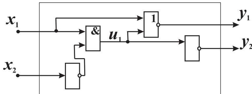
Рис. 3. Оптимизированная комбинационная схема
