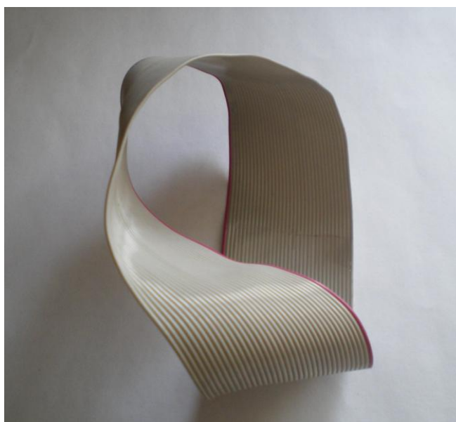
Рис. 2. Катушка индуктивности, изготовленная из плоскости параллельных проводников
