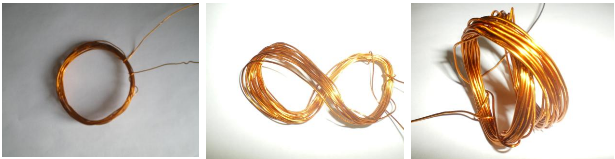
Рис. 4. Предлагаемый способ изготовления многослойной катушки индуктивности
