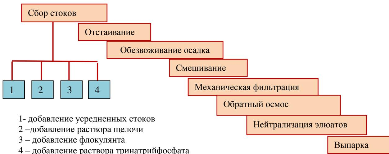
Рисунок 4 – Схема процесса очистки сточных вод
