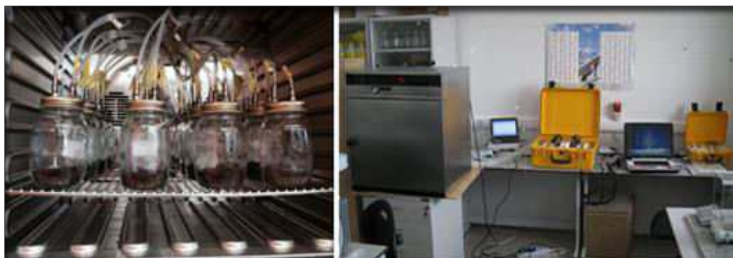
Рисунок 2 - Программируемый инкубатор с Пельтье-охлаждением (Mettmert 500) и 16-канальный мультиплексер (LiCor 8150), соединенный с инфракрасным анализатором (LiCor 8100)
