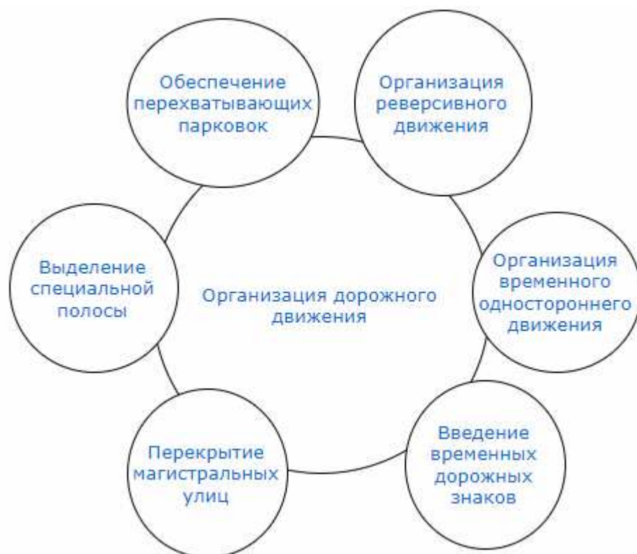
Рисунок 1.4.2 – Мероприятия по организации дорожного движения и обеспечения безопасности дорожного движения во время проведения Универсиады
