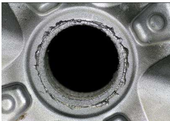
Рисунок 1.5 – Вырывы в ступичной части
