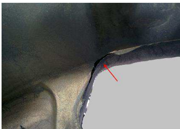
Рисунок 1.6 – Вырывы в зоне смыкания пуансон–матрица
