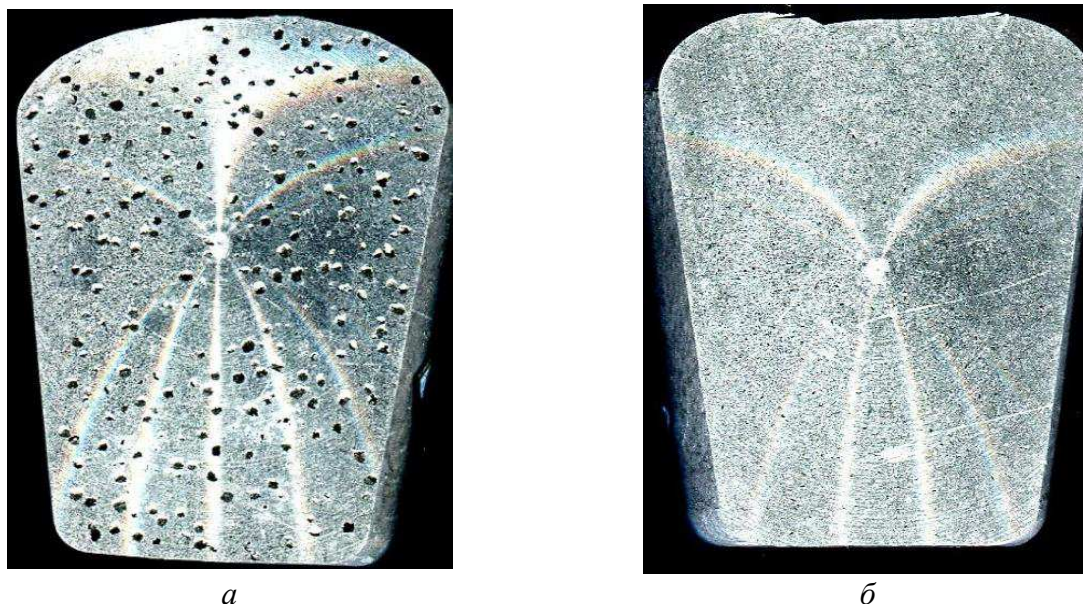
Рисунок 1.9 – Сечение проб на индекс плотности. а – проба затвердевшая в вакууме (низкое давление); б – проба затвердевшая при атмосферном давлении
