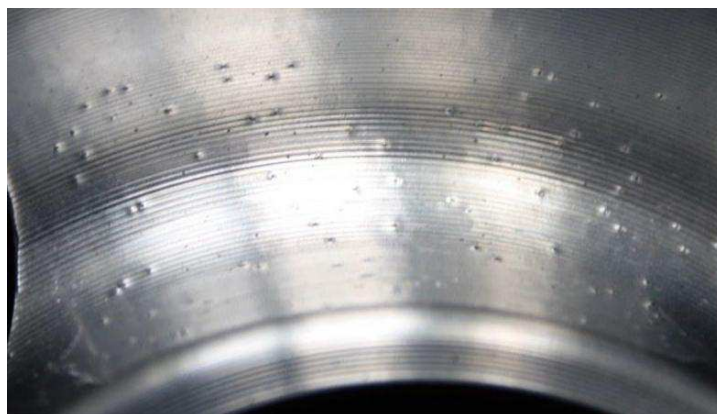
Рисунок 1.7 – Пористость на лицевой поверхности алюминиевого диска автомобильного колеса
