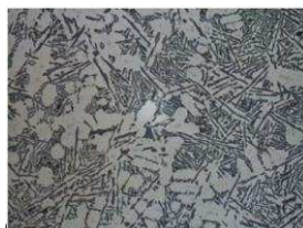
Рисунок 5 – Микроструктура немодифицированного сплава АК12 (увеличение 200)
