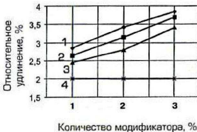
Рисунок 18 – Изменение пластичности при введении модификатора №1 различного гранулометрического состава:
