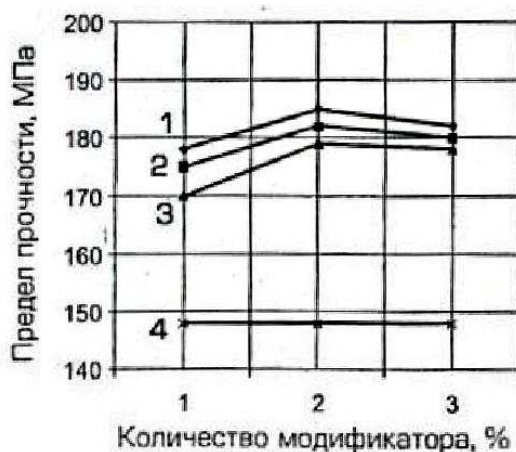
Рисунок 17 – Изменение предела прочности при введении модификатора №1 различного гранулометрического состава:
