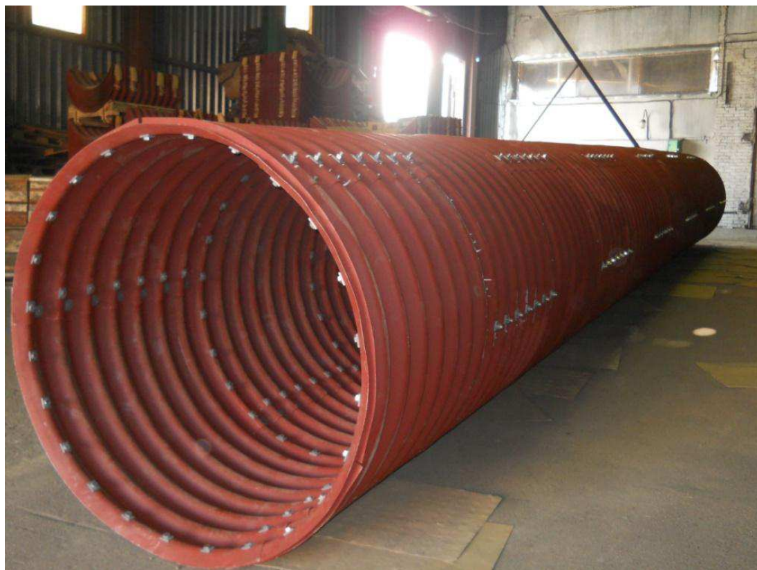
Рисунок 1 – Металлическая водопропускная гофрированная труба диаметром 1,5 м.
