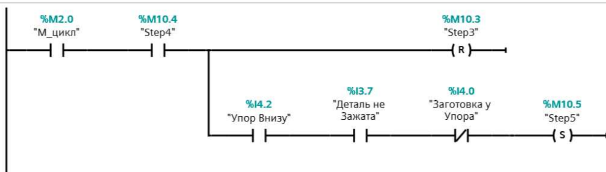
Рисунок 6.39 – Схема выполнения пятого шага
