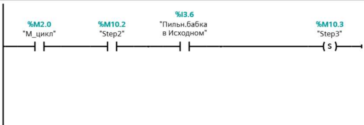
Рисунок 6.37 – Схема выполнения третьего шага
