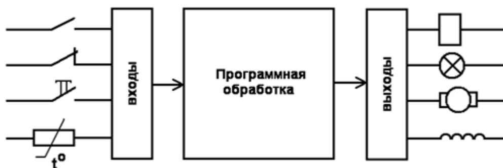
Рисунок 2.4 – Принцип работы ПЛК
