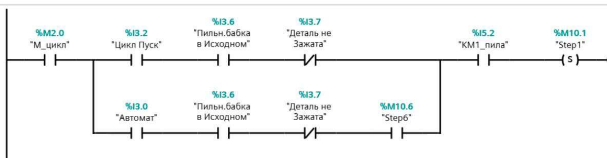
Рисунок 6.35 – Схема выполнения первого шага
