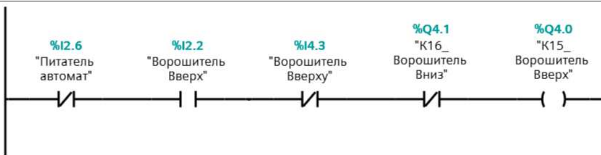
Рисунок 6.45 – Схема включения ворошителя вверх
