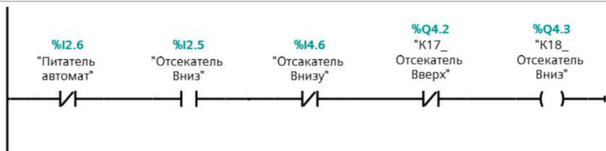
Рисунок 6.44 – Схема включения отсекаателя вниз
