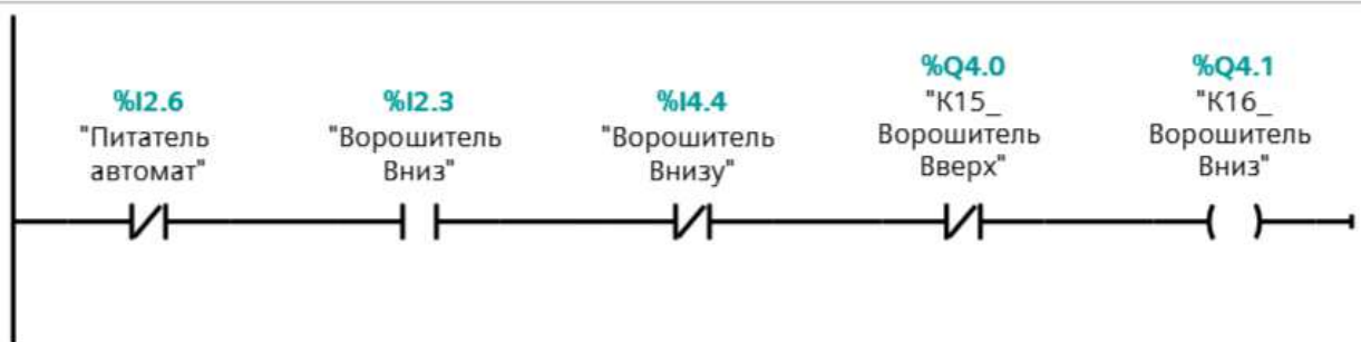
Рисунок 6.46 – Схема включения ворошителя вниз
