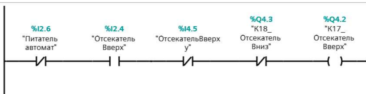
Рисунок 6.43 – Схема включения отсекателя вверх
