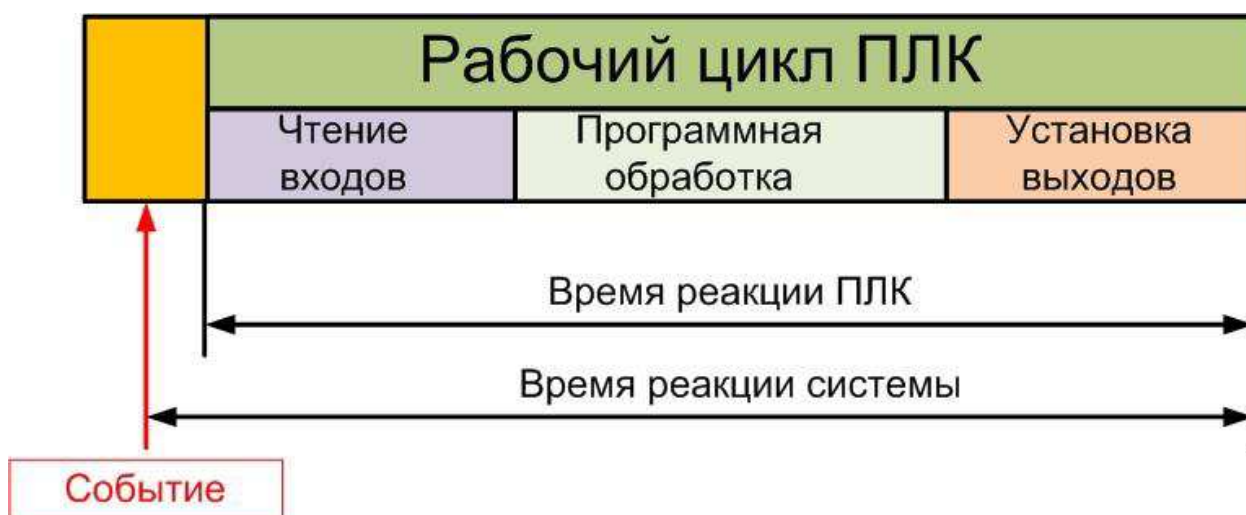
Рисунок 2.5 – Цикл работы ПЛК
