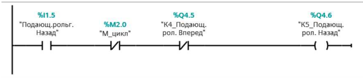
Рисунок 6.27 – Схема включения подающего рольганга назад
