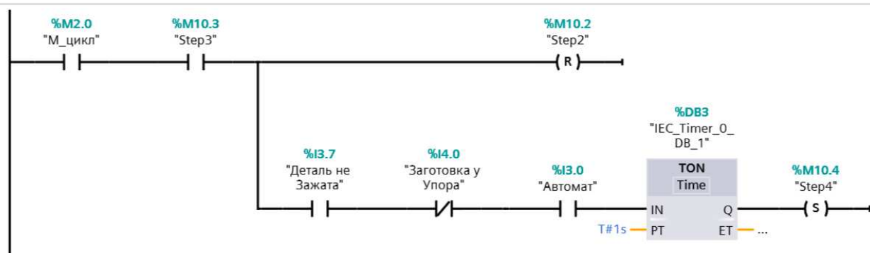
Рисунок 6.38 – Схема выполнения четвертого шага
