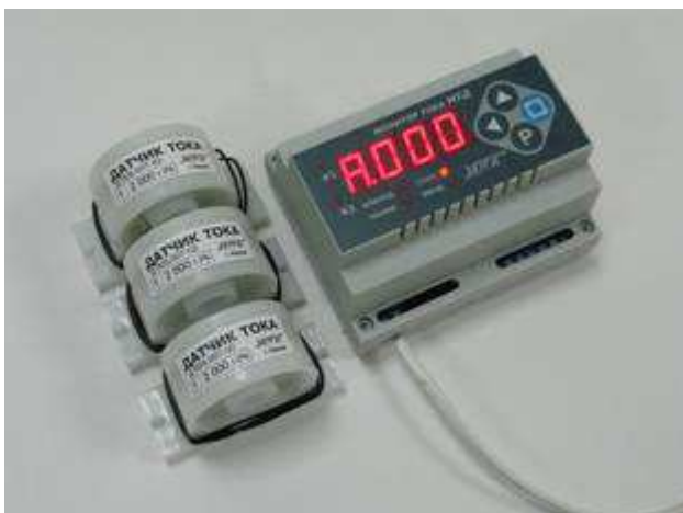
Рисунок 2.11 – Устройство защиты электродвигателя МТД с тремя тороидальными датчиками тока
