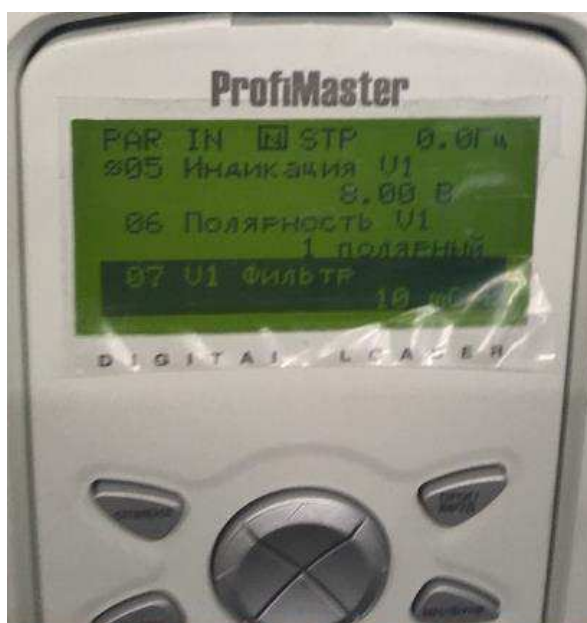
Рисунок 6.12 – Предельное значение напряжения аналогового входа
