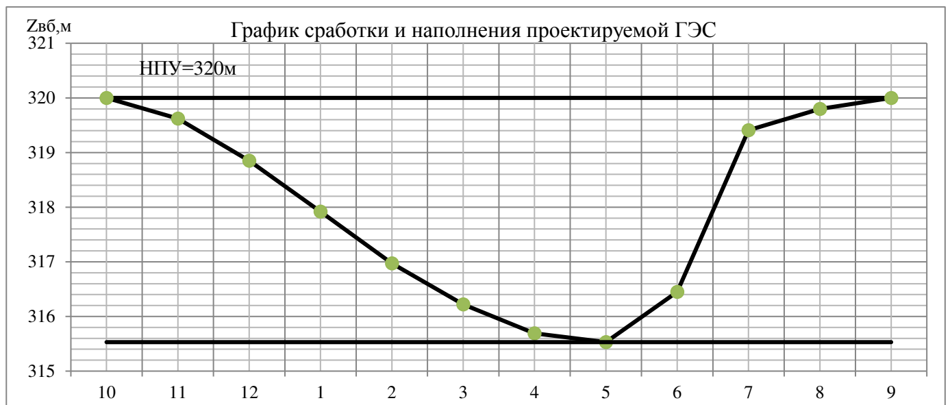
Рисунок 15- График сработки и наполнения проектируемой ГЭС в маловодный год
