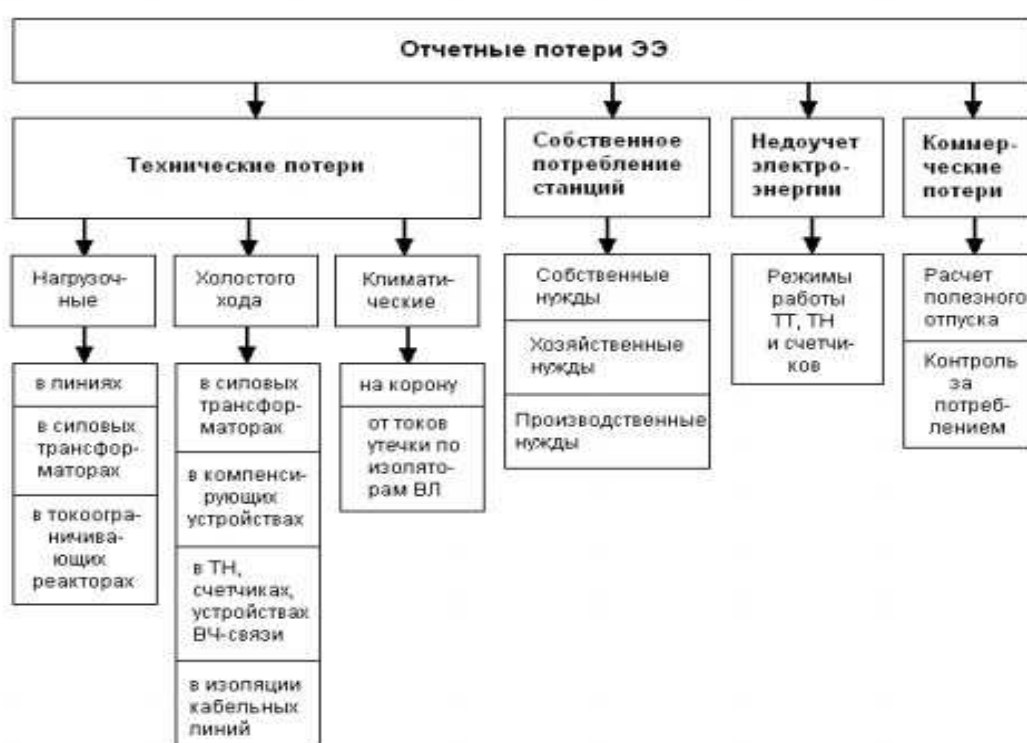
Рисунок 9.1 – Общая структура расхода электроэнергии на электростанции
